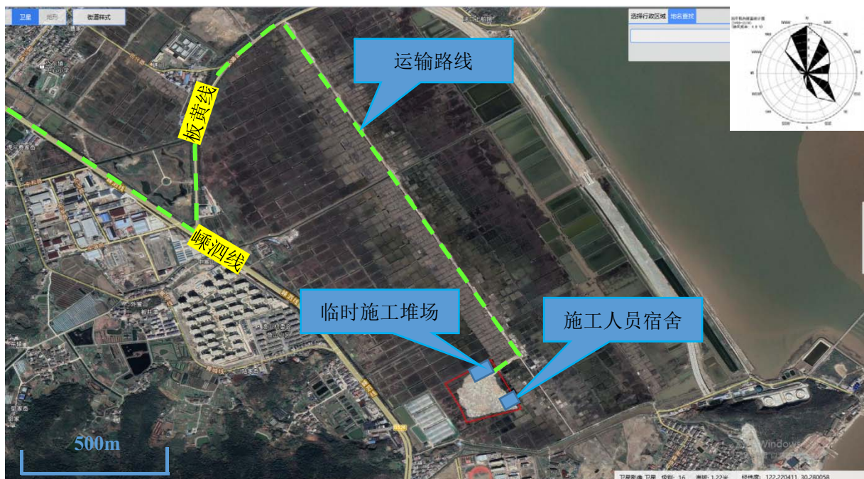
图 3.3-2 本项目施工期施工场地布置示意图
